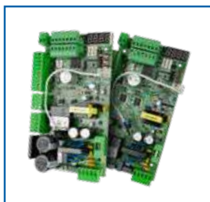
Centrale de commande EVO de nouvelle génération, conforme au règlement européen (UE) 2023/826, avec une consommation en veille inférieure à 0,5 W.
